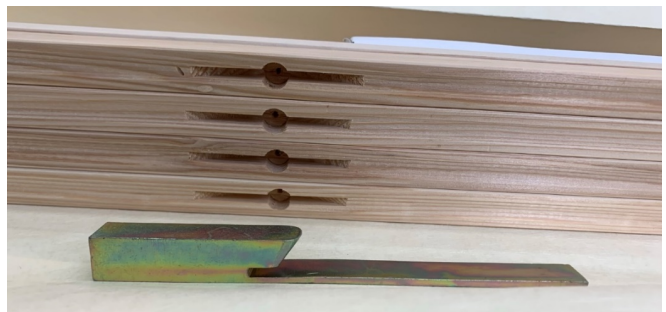
図 31 隠し釘用の縁と止め打ち金具
