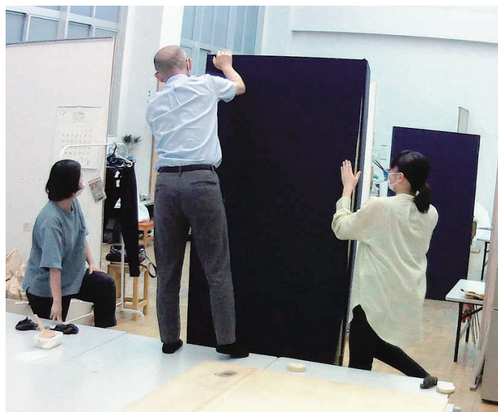
図46-1 蝶番の切れ目の部分は、はさみで切り込みを入れながら貼る
