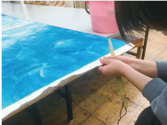
図37 糊代に水を浸けしばらく置き竹ベラを這わせる
