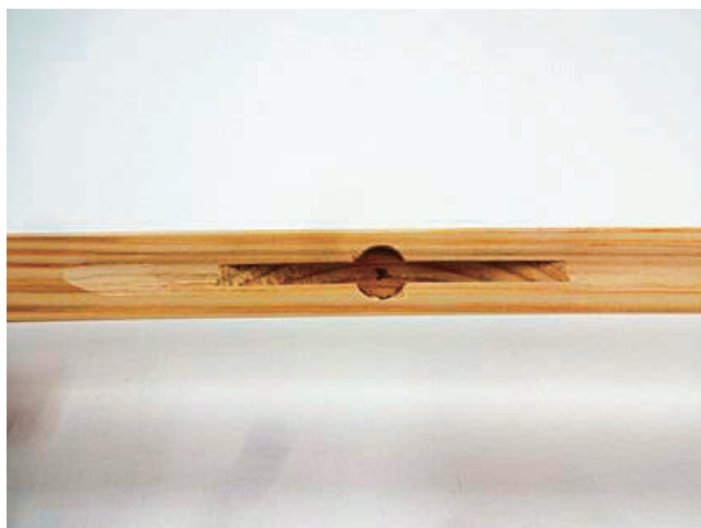
図 51 木枠の内側 溝と隠し釘穴
