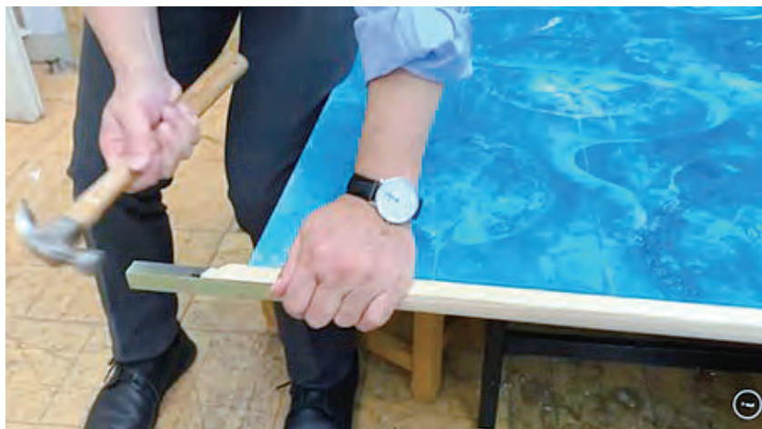
図 57 止め打ち金具を嵌めて、少しずつ打ち込む
