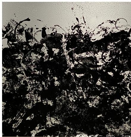
図23 前面パネル試作 透明ガラス板にプラスチックゴミを転写
