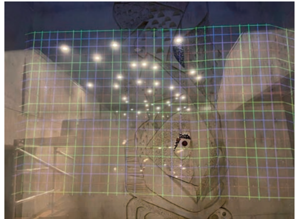
■ (上左 / 上右 / 下左) レリーフの形状を正確に把握するため格子状のテストパターンを投影しそれぞれのポイントを記録する。
