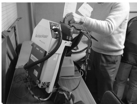
図 18 バックパック型のレーザー照射システム
