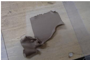
図 3-6 破れた土の写真
