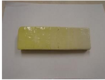
図 2-4 図 2-3 の顔料を用いて制作したテストピースの 焼成後の写真
