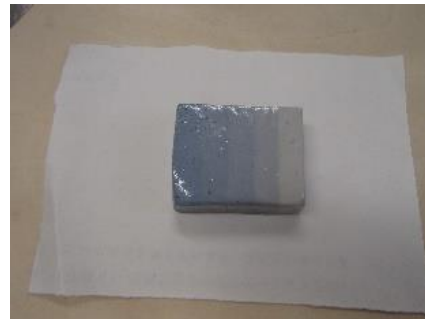
図 2-8 図 2-7 の顔料を用いて制作したテストピースの焼成後写真
