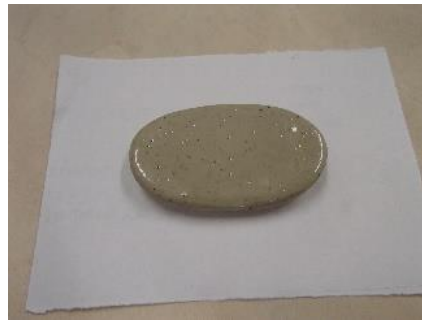
図 2-6 図 2-5 の顔料を用いて制作したテストピースの焼成後の写真
