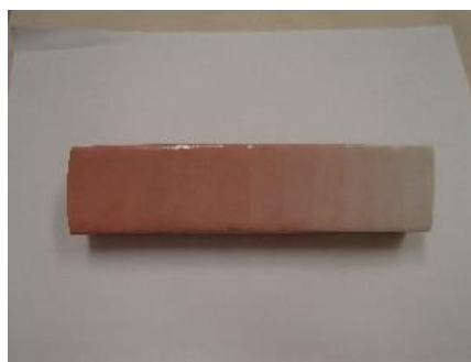
図 2-2 図 2-1 の顔料を用いて制作したテストピースの焼成後の写真
