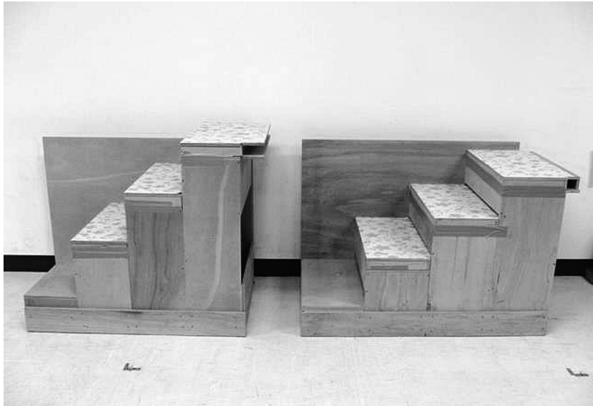
図3 木製階段の比較 (左：一般家庭で標準的な階段 右：公共施設の基準の階段)
